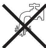
N'installez pas votre combiné ni en extérieur, ni dans une pièce humide (salle d'eau, salle de bains, buanderie, cuisine, etc.) à moins de 1,50 m d'un point d'eau. Pour bénéficier d'une qualité audio optimale, votre téléphone doit être utilisé à une température ambiante comprise entre + 5 °C et + 40 °C.
