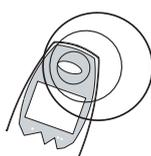
Votre téléphone DECT dispose d'une portée radio d'environ 50 mètres en intérieur et jusqu'à 300 mètres dans un espace dégagé. La présence immédiate de masses métalliques (d'une télévision par exemple) ou de tout appareil électrique est susceptible de réduire la portée. Des zones sans réception peuvent apparaître du fait des particularités de la construction. Ceci peut entraîner de brèves interruptions de la conversation, provoquées par une mauvaise transmission.
