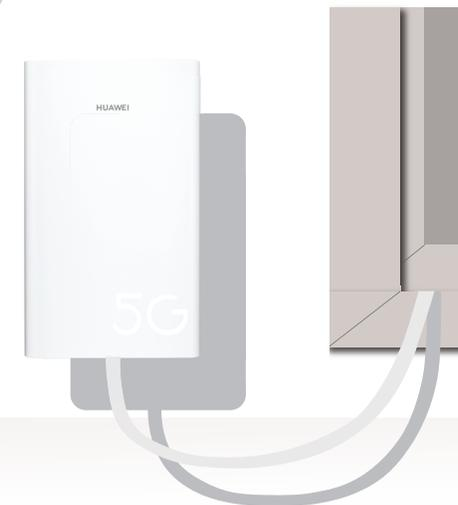
Amenez le câble de réseau blindé de l'unité extérieure jusqu'à l'unité intérieure en le faisant passer par une fenêtre ou une porte. Le câble fourni a été conçu de telle sorte qu'il peut résister aux frictions et aux pressions qui endommagent les câbles standards.
