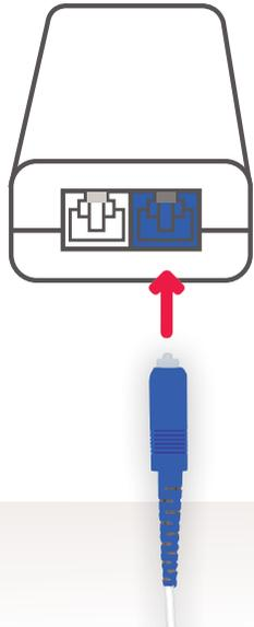
Inserire il cavo di rete armato (10m) proveniente dall'unità esterna nella presa blu dell'unità interna (WAN&POWER).
