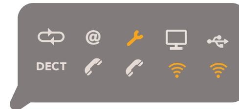
I pannelli evidenziati in giallo dovrebbero essere accesi per segnalare il corretto funzionamento del modem.
