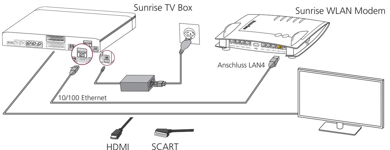
5. Schliessen Sie dann Ihr TV-Gerät an die Sunrise TV Box an (HDMI/SCART) und verbinden Sie diese mit dem Strom. Wählen Sie die richtige TV-Eingangsquelle (HDMI/SCART), sobald der blaue Knopf bei der Sunrise TV Box permanent leuchtet.
