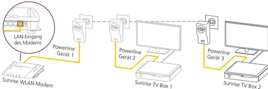
**1** Verbinden Sie nun das Powerline **Gerät 3** mit der **Sunrise TV Box** und stecken dieses anschliessend ans Stromnetz.
