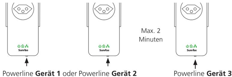
**Gut zu wissen:** Ist das Powerline **Gerät 3** richtig installiert, so leuchten bei diesem alle Lämpchen.
