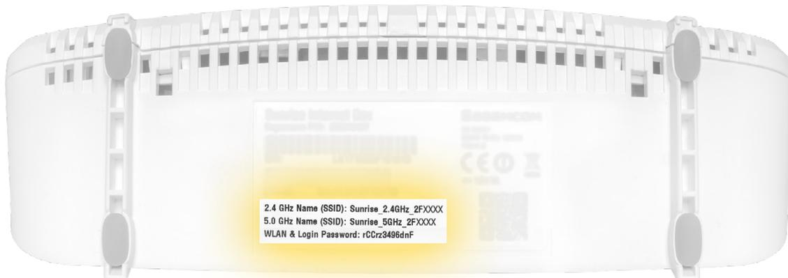
Connectez maintenant vos appareils aux deux réseaux (2.4 et 5 GHz). Vous trouverez les informations nécessaires sur la face inférieure de la box.
