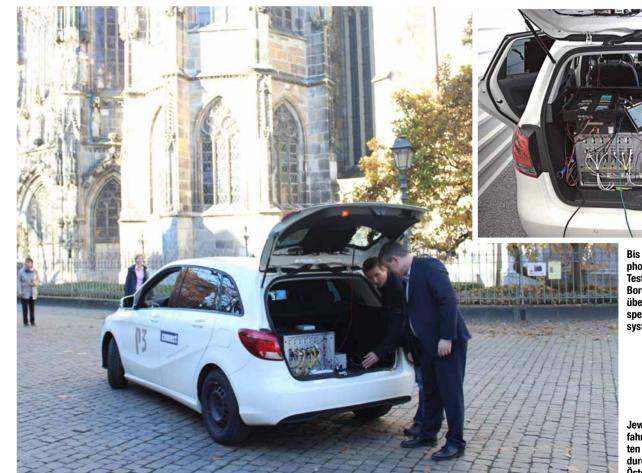
Bis zu zwölf Smartphones hatten die Testfahrzeuge an Bord – gesteuert und überwacht von den spezialisierten Messsystemen von P3.
