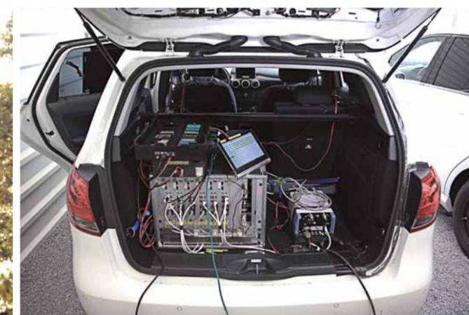
Bis zu zwölf Smartphones hatten die Testfahrzeuge an Bord – gesteuert und überwacht von den spezialisierten Messsystemen von P3.
