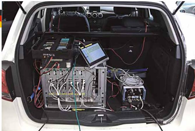
Die beiden Fahrzeuge, mit denen die Drivetests durchgeführt wurden, hatten für die Sprachmessungen jeweils acht Samsung Galaxy S5 an Bord.
