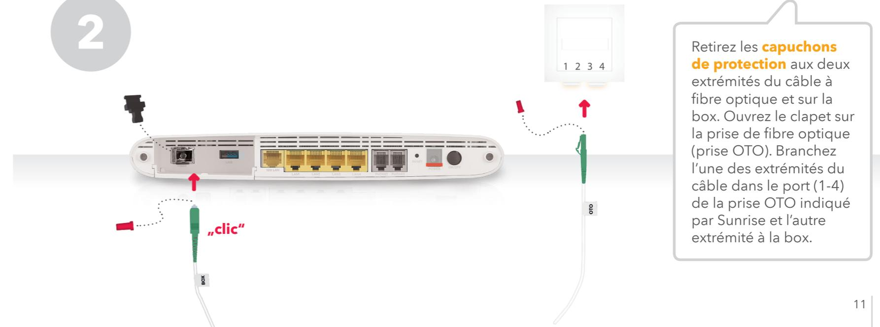
Retirez les **capuchons de protection** aux deux extrémités du câble à fibre optique et sur la box. Ouvrez le clapet sur la prise de fibre optique (prise OTO). Branchez l'une des extrémités du câble dans le port (1-4) de la prise OTO indiqué par Sunrise et l'autre extrémité à la box.
